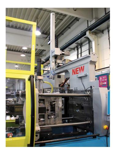
Das neue servomotorische Linearhandling BOY LR5 mit einem attraktiven Preis-Leistungs-Verhältnis ist eine komplette Neuentwicklung des Herstellers von Spritzgießautomaten bis 1.000 kN Schließkraft.
