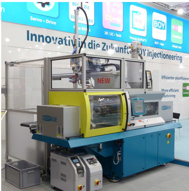
Foto(s): > Komplette Produktionszelle, bestehend aus BOY60 E, Handling und CE-gerechter Schutzumhausung
