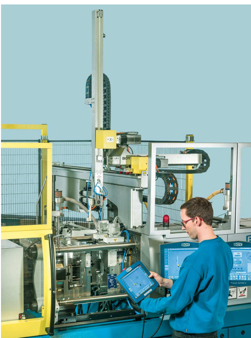
Foto(s): > BOY-Handling LR 5, montiert auf einem BOY-Spritzgießautomaten
