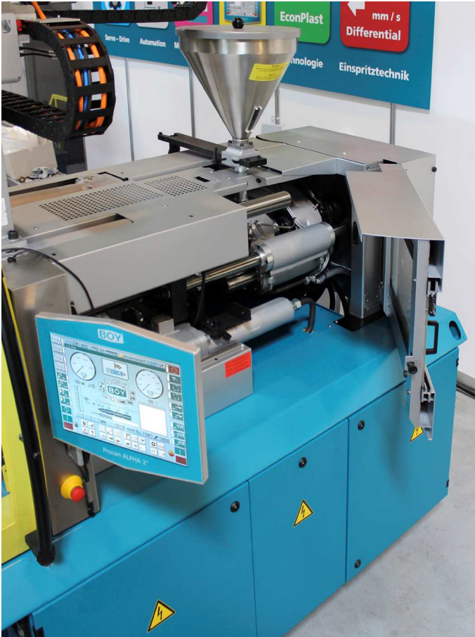
Foto(s): > BOY 50 E mit neuer Spritzeinheit SP 170 in neuem Design
