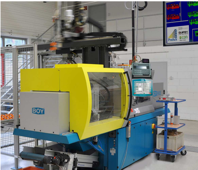
Foto(s): > BOY-Spritzgießautomat mit ProSeS BDE-System
