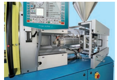
Die ausschwenkbare Spritzinheit erleichtert Umrüstungen und Wartungsarbeiten
