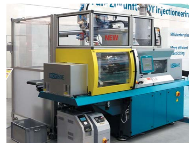
^ BOY 60 E mit kompletter Automation - für den jeweiligen Anwendungszweck perfekt ausgerüstet.
