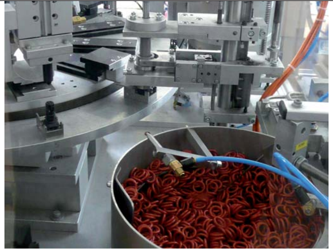
Die vollautomatische Montage gehört zu den Wachstumsfeldern von Fleig. Die integrierte 100-%-Prüfung umfasst die Abfrage zum richtigen Sitz der O-Ringe mittels Lichtschranken, die Farberkennung sowie die Dichtheitskontrolle durch einen Vakuumdrucksensor.
