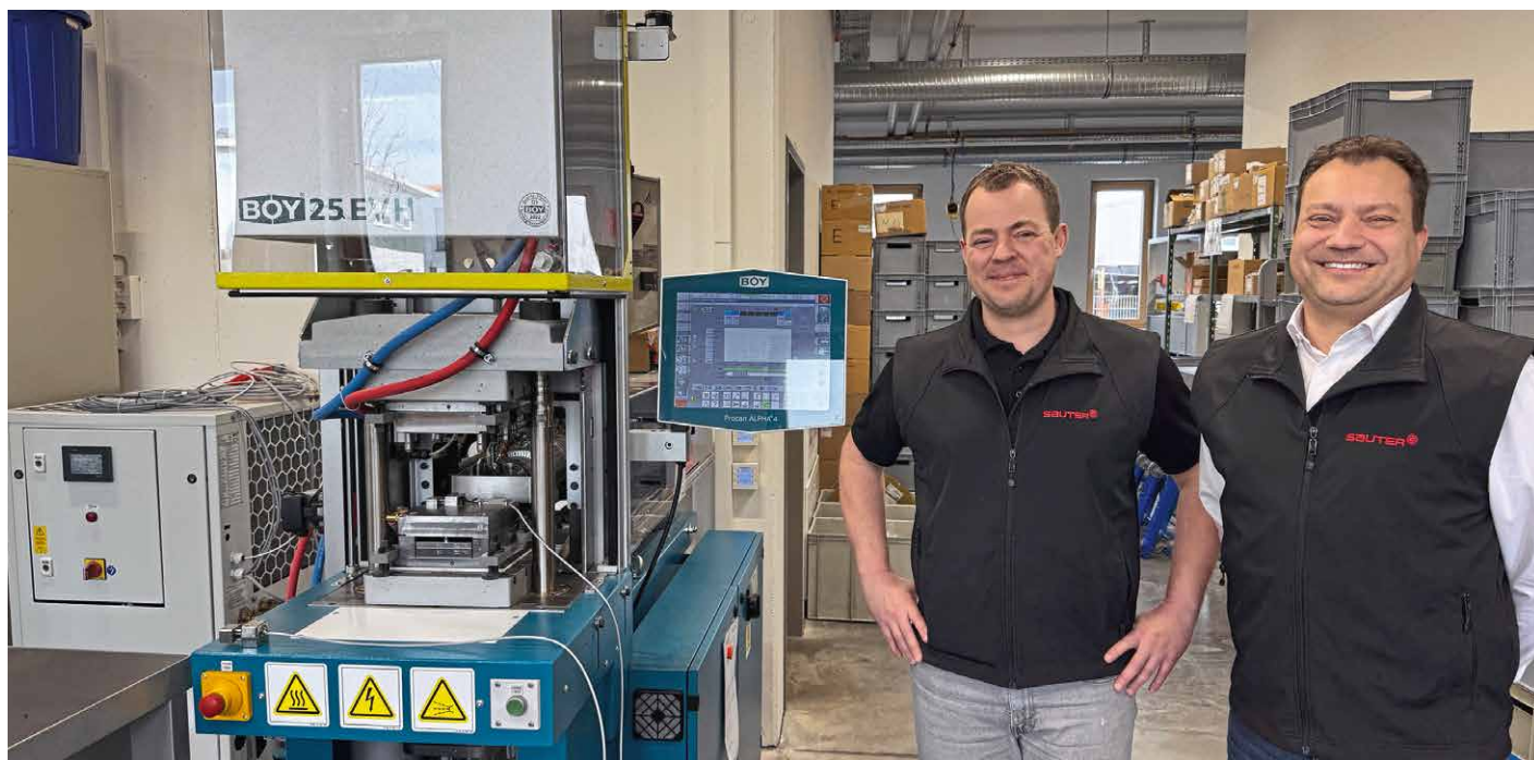
Philipp Geiges (rechts), Geschäftsführer der Werner Sauter GmbH, und Dominik Geiges, technischer Leiter und Prokurist, vor der Vertikalspritzgießmaschine Boy 25 E V H. Auf der kompakten Anlage wird eine Sensorplatine inklusive angelöteter Leitung mit dem Hotmelt-Material Macro-melt PA678 von Henkel prozesssicher umspritzt.
