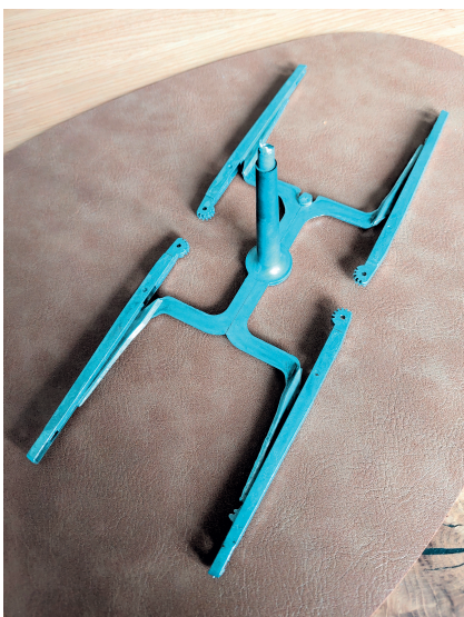
Die vier Schenkel werden manuell vom Anguss abgeklipst. Dazu muss die Anbindung präzise konstruiert sein. © Hanser/C. Doriát
