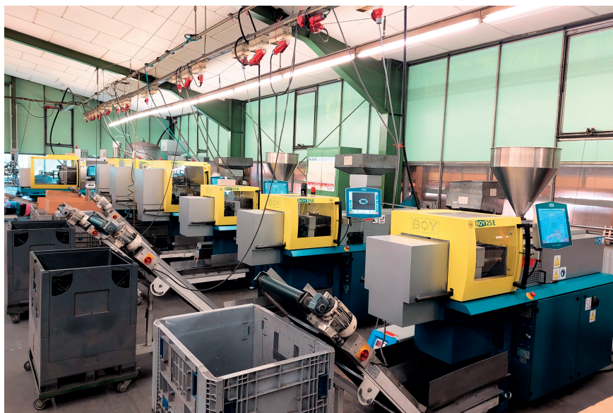
Blick in die Produktionshalle bei Intertech Zeichengeräte, in der auf einer Seite die Boy-Spritzgießautomaten aufgereiht sind. Vis-à-vis stehen (nicht im Bild) zwei Druckguss-Anlagen. © Hanser/C. Doriat
