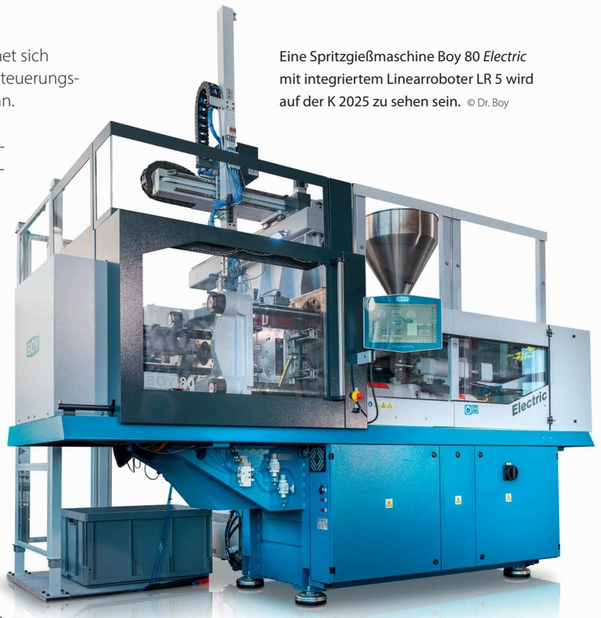
Das Wiederanfahren nach einer Störung ist stark vereinfacht, weil alle Positionsdaten bekannt sind. Damit werden mechanische Kollisionen zwischen Werkzeug und Roboter vermieden.
