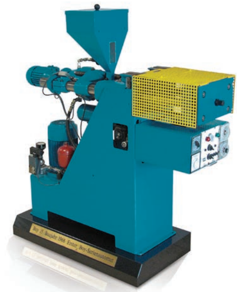
BOY 15 – weltweit erster Spritzgießautomat nach dem vollhydraulischen Zwei-Platten-Schließsystem aus dem Jahre 1968.
