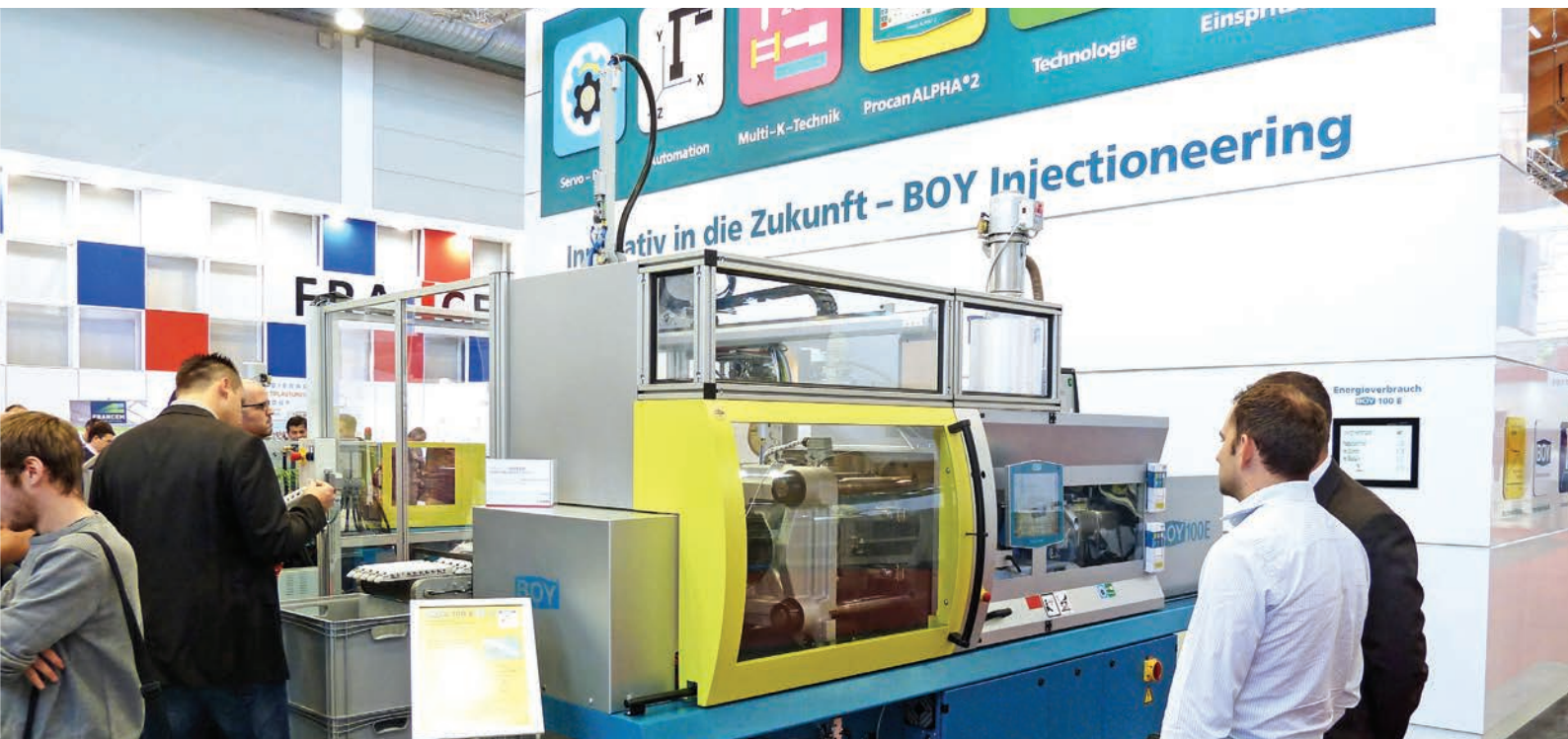
Eine komplette Fertigungsanlage: Spritzgießautomat BOY 100 E mit Vier-Achs-Industrieroboterhandling LR 5 sowie einer CE-gerechten Schutzumhausung.
