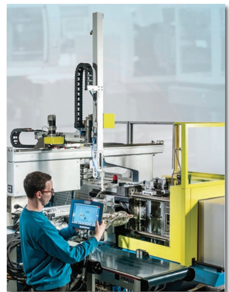
Eine komplette Fertigungsanlage: Spritzgießautomat BOY 100 E mit Vier-Achs-Industrieroboterhandling LR 5 sowie einer CE-gerechten Schutzumhausung.
