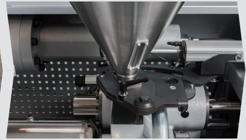
Elektrisch verfahrbarer Materialtrichter / -förderer zum einfacheren Nachfüllen
