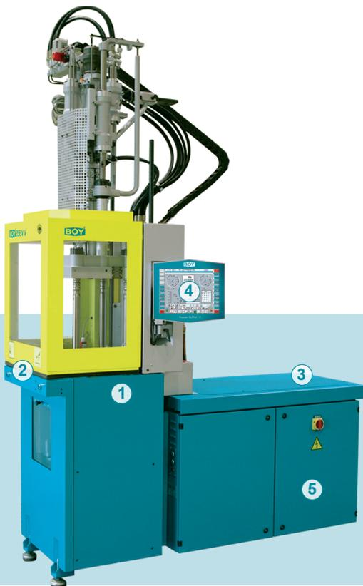
Die untere Schließplatte **steht fest**. Ein Verrutschen der Einlegeteile während des Schließvorganges ist damit ausgeschlossen.
