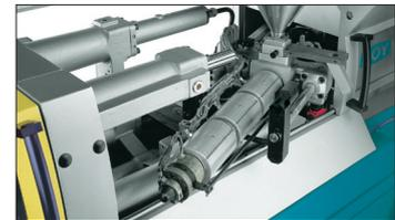
Die ausschwenkbare Spritzeinheit erleichtert Umrüstungen und Wartungsarbeiten
