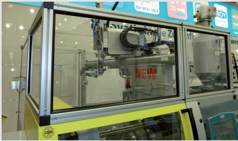
Auf der Schließeinheit positionierter Industrieroboter mit Schutzumhausung
