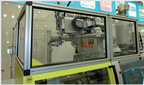
Auf der Schließeinheit positionierter Industrieroboter mit Schutzumhausung
