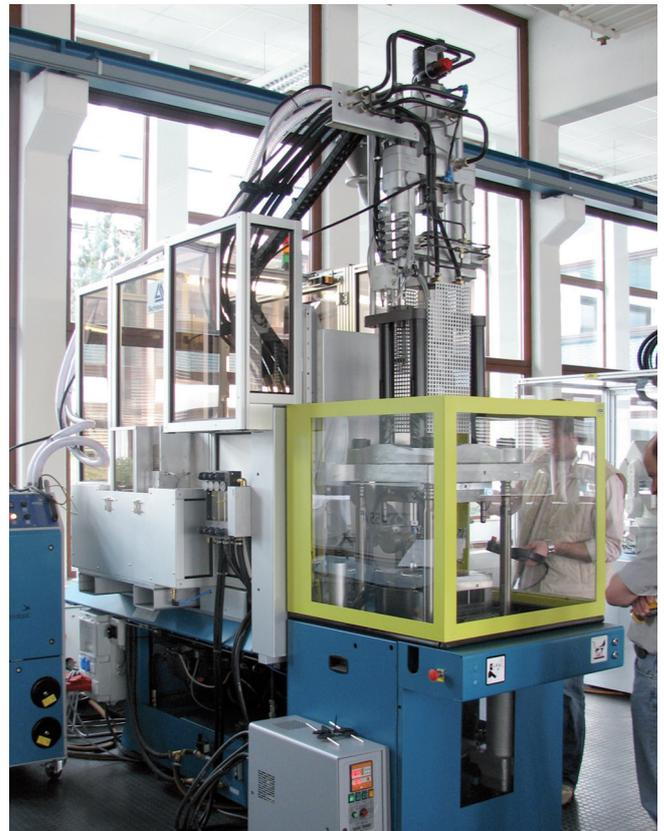
Großzügig dimensionierte Holmenabstände bieten darüber hinaus ausreichend Platz für den Einbau von großen und Mehrfach-Werkzeugen. Großvolumige Umspritzungen mit insgesamt sieben verschiedenen Schneckendurchmessern sind somit problemlos möglich.
