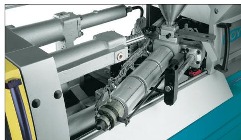
Die ausschwenkbare Spritzeinheit erleichtert Umrüstungen und Wartungsarbeiten
