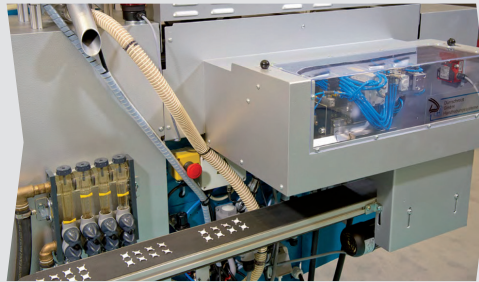
Kompaktes Entnahmehandling mit Teileabtransport auf der Maschinenrückseite
