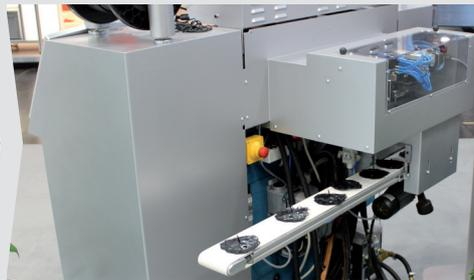
Kompaktes Entnahmehandling mit Teileabtransport auf der Maschinenrückseite
