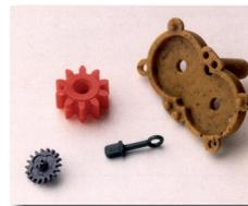
spezifische Spritzdrücke bis zu 3128 bar zur Verfügung. Die intelligente Konstruktion ist ideal zugeschnitten auf die speziellen Anforderungen des Mikrospritzgusses.
