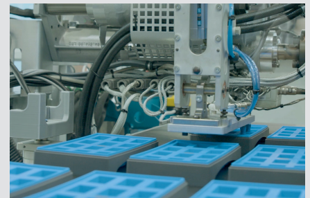
Um 90° geschwenkte Greiferhand legt die Spritzteile auf ein Förderband ab
