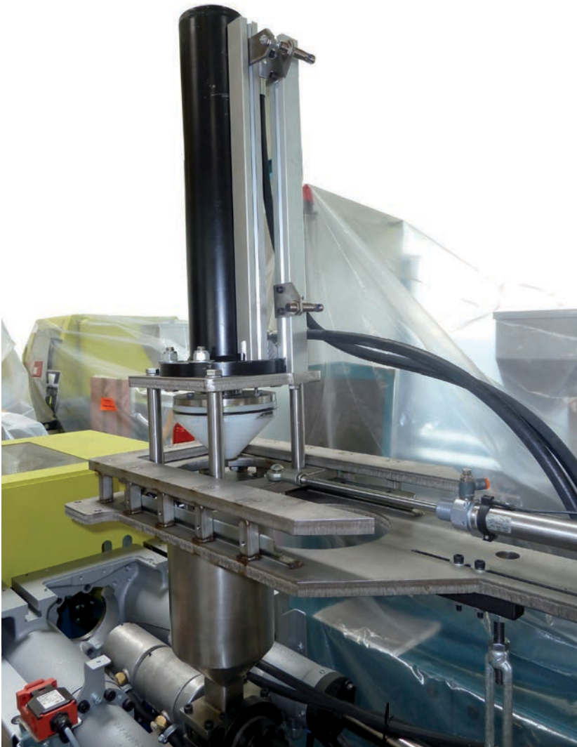
Hydraulische Stopfvorrichtung auf der Plastifiziereinheit des Spritzgießautomaten
