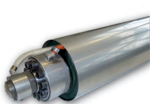
Bild 4: Die EconPlast-Einheiten sind für alle BOY Spritzgießmaschinen der E-Baureihe ab 24 mm Schneckendurchmesser optional erhältlich
